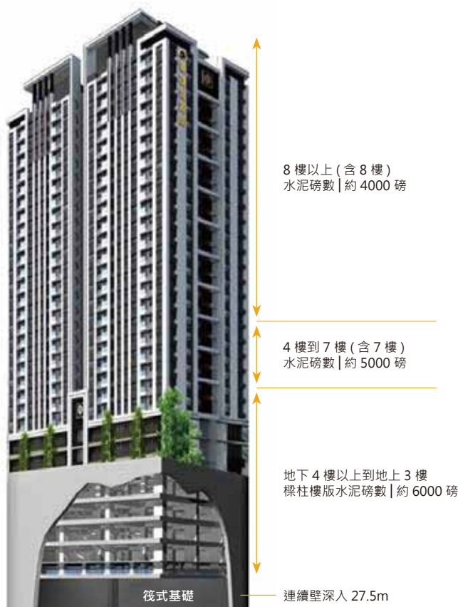
台南遠雄新源邸結構基礎設計
